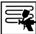
Aplicar 3 a 4 passadas com intervalo de 5 a 10 min entre passadas.
